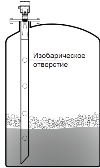
Монтаж успокоительной трубы
